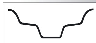
MT-Felge geeignet für Reifen mit und ohne Schlauch (TT und TL)
