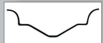
Zweiteilige Felge mit geteilter Radscheibe für Motorrollerreifen mit Schlauch (TT)
